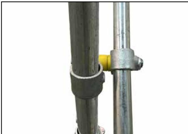
**7.** Vérifiez que le cadre est bien parallèle. La barrière éclusene fonctionnera pas correctement dans le cas contraire. Si nécessaire, ajustez le cadre en faisant pivoter les raccords.
