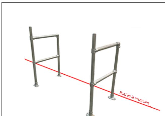
3. Alignez chaque cadre aux trous précédemment percés. Il pourra être nécessaire d'ajuster légèrement les raccords afin de bien centrer le système sur les trous.
