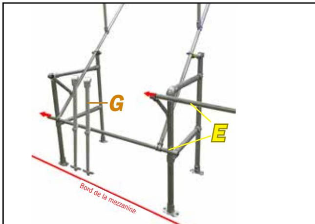
**7.** Sur le bord principal de la mezzanine, insérez 2 tubes horizontaux (E) aux extrémités des tubes en porte-à-faux. À cette même étape, ajoutez 2 montants (G) dotés de supports pour plinthe aux tubes horizontaux (E).
