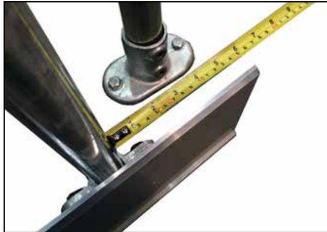
**13.** Vérifiez que la plinthe (H) est bien centrée sur le cadre et serrez les écrous au couple de 15 Nm afin de vous assurer qu'elle est bien fixée.
