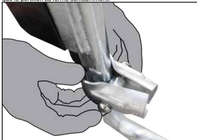
**P.** Ajouter le raccord sur la partie basse du portillon et insérer le lisse intermédiaire. Utiliser un embout de 6mm pour serrer les boulons M10 fournis dans l'écrou d'accouplement.
