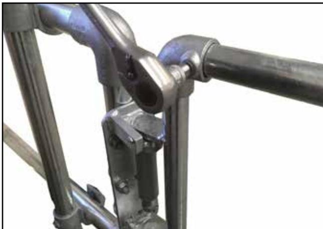
**G.** Détachez le cadre tubulaire de l'ensemble charnière en desserrant les vis sans tête des raccords supérieur et inférieur, à l'aide d'une clé hexagonale, conformément à l'illustration ci-dessus.
