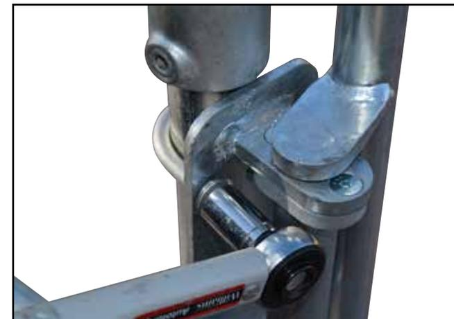
**E.** Serrez les écrous des étriers au couple de 25Nm, à l'aide de la douille de 13 ou 17 mm et de la clé dynamométrique.
