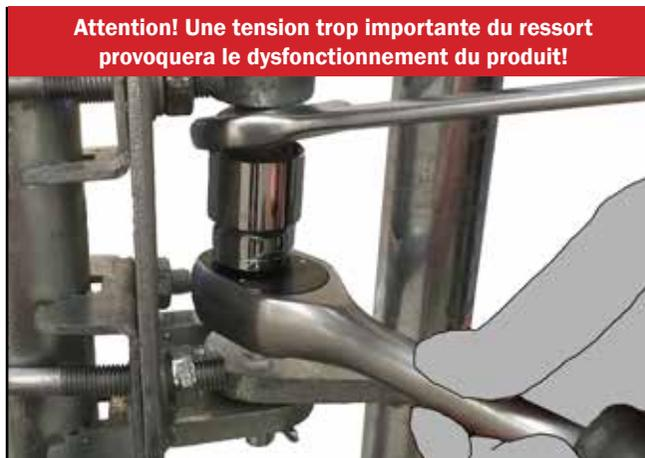
**Attention!** Une tension trop importante du ressort provoquera le dysfonctionnement du produit!
