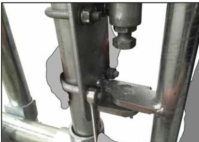
**D.** Faites passer l'étrier fileté autour du montant / structure d'appui, puis à travers les trous **inférieurs** de la plaque de fixation. Assemblez l'étrier fileté à la plaque de fixation à l'aide d'une rondelle élastique, d'une rondelle plate et d'un écrou.
