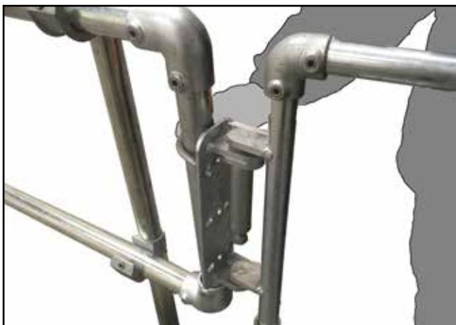
**A.** Alignez la plaque de fixation sur la face interne de l'ouverture, de manière à ce que la main courante du portillon de sécurité s'aligne sur la partie supérieure du système de garde-corps. Sélectionnez un étrier fileté à la bonne taille et faites-le passer autour du montant / structure d'appui, puis à travers les trous supérieurs de la plaque de fixation..
