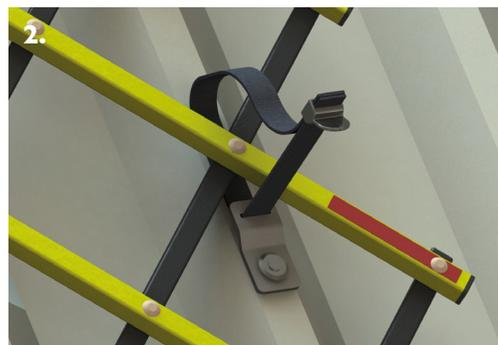
En veillant à ce que les deux supports situés le long du bord le plus long soient installés en premier, puis à ce que les sangles soient déployées afin de fixer le couvercle en place avant d'installer les autres.
