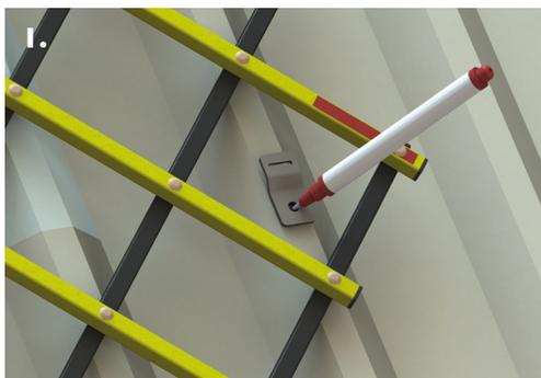
**Remarque :** la connexion entre le support et la sangle doit être située à l'avant-dernier point d'intersection des barres du treillis, au sommet d'une nervure du profil du toit.
