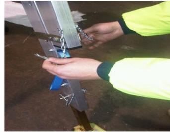
Ajustez la hauteur en retirant les deux broches de montant et en roulant la plateforme solaire contre le mur jusqu'à la hauteur désirée et remplacez les deux broches de montant en veillant également à replacer les pinces de sécurité en R fournies. Après avoir ajusté la hauteur, il faudra réajuster la plateforme solaire en déplaçant les pieds dans une direction ou l'autre contre le mur.
