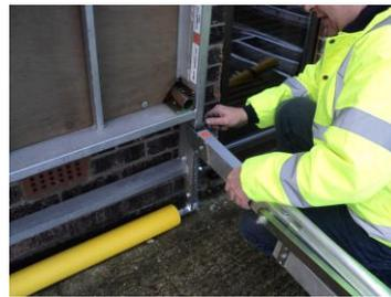
Fixez les deux jambes à l'aide des broches et des goupilles beta fournies et assurez-vous que les broches sont bien insérées depuis l'extérieur afin d'éviter que la goupille beta ne soit expulsée. **NE PAS OUBLIER :** Fixez les montants dans le trou « Utilisation standard » marqué sur la partie inférieure de la plateforme.
