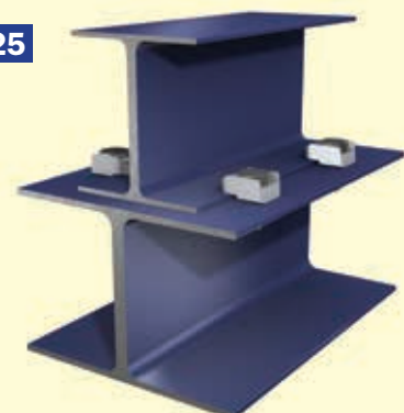
Poutre en I sur poutre H percée
