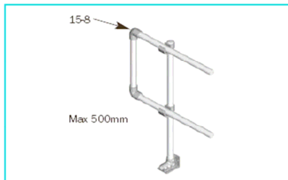
En réalisant un retour en "D", avec 2 raccords Kee Klamp® référence 15-8
